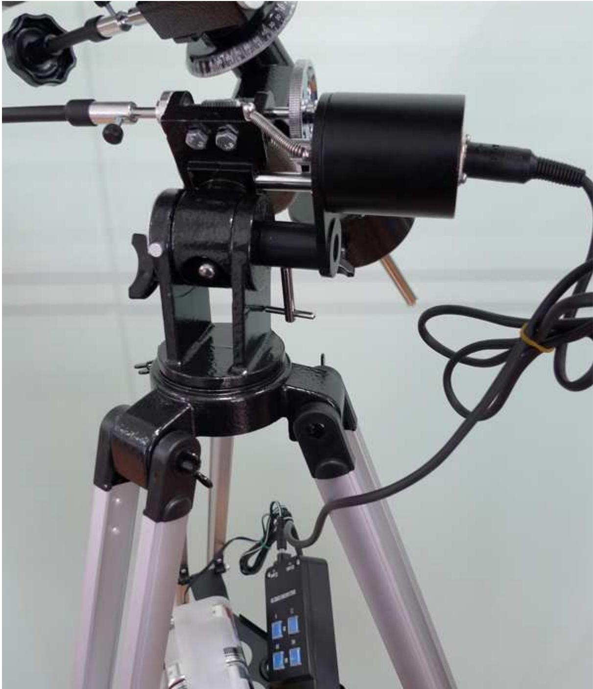
**Instrucciones de instalación: motor para telescopios con montura EQ2**
