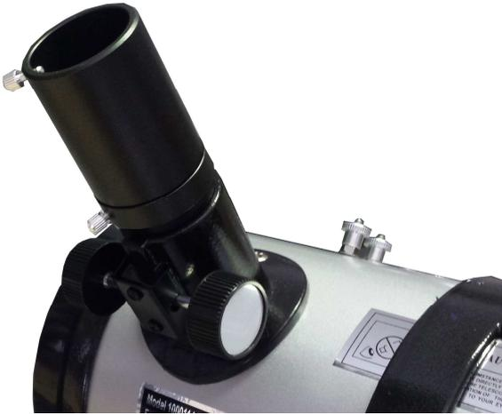
Desserrer et retirer les vis de boulons sur le tube avant et régler le viseur sur les vis.
