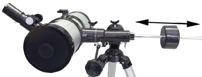
Vous avez maintenant ajusté l'axe de l'ascension droite. Cela signifie que cet axe sera maintenant toujours à niveau, indépendamment de la position dans laquelle le télescope est.
