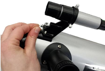
Vissez la vis de blocage sur le réglage de l'altitude.
