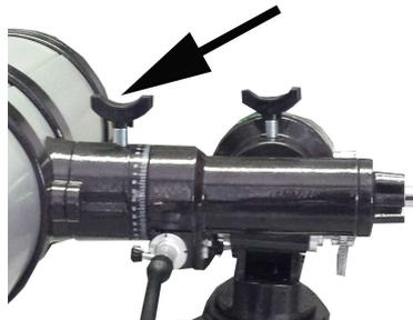
Pour corriger cela, ouvrez légèrement le fermoir de la bague du tube télescopique, de sorte que le tube puisse être déplacé en arrière et en avant. Déplacez le tube jusqu'à ce qu'il ne se déplace plus par lui-même (ce qui signifie qu'il ne s'effondrera pas sur un côté), puis refermez la pince de déclinaison.
