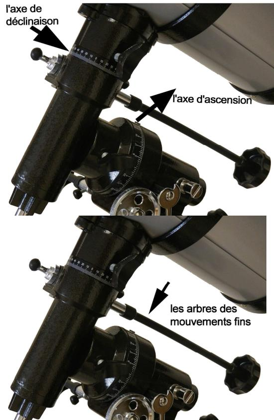
Le réglage du montage est important car les deux axes doivent se tenir debout. Cela a pour effet que le télescope, quelle que soit sa position, ne basculera pas latéralement en raison de la surcharge unilatérale. Pensez à une balançoire: si un côté a plus de charge sur elle, alors il descendra vers le bas.
