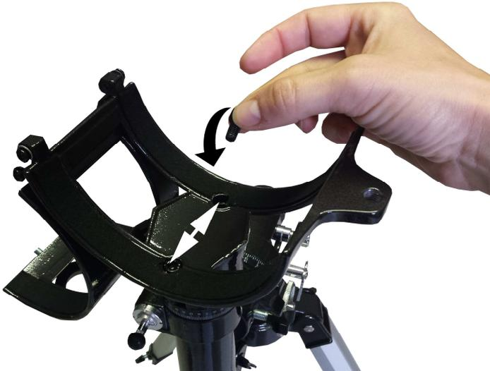
Fixez les arbres des mouvements fins. Pour ce faire, retirez les petits crampons de protection en caoutchouc des boulons de positionnement, si nécessaire.
