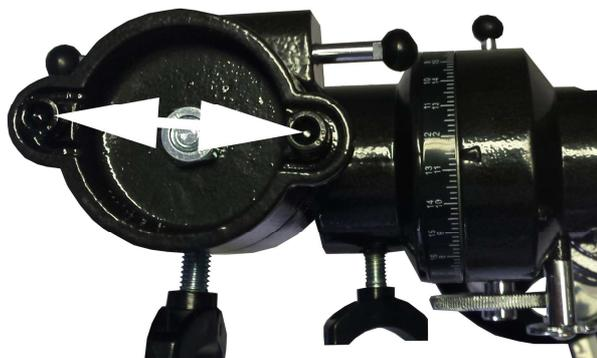
Fixez correctement la bague du télescope. Remplacez les vis dans les trous de la bague du tube télescopique et serrez-les.
